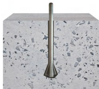
自锁锚固机理及受力原理图
